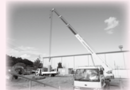
教習風景 (トラッククレーン(つり上げ荷重7t))
