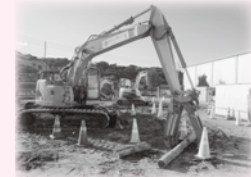
新たに追加された解体用建設機械のアタッチメント(下)
