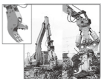
コンクリート圧碎機 （コンクリート構造物を砕く）
