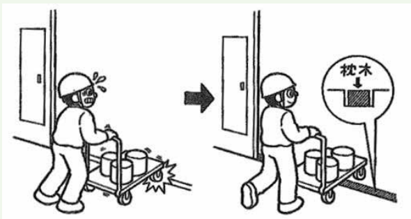
通路の改善例
